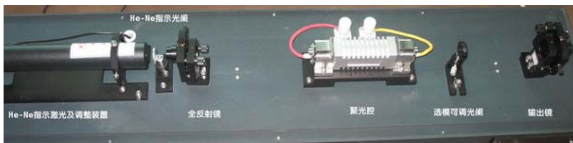
图 14.4: 半共焦腔结构的氙灯泵浦Nd:YAG 激光系统。
