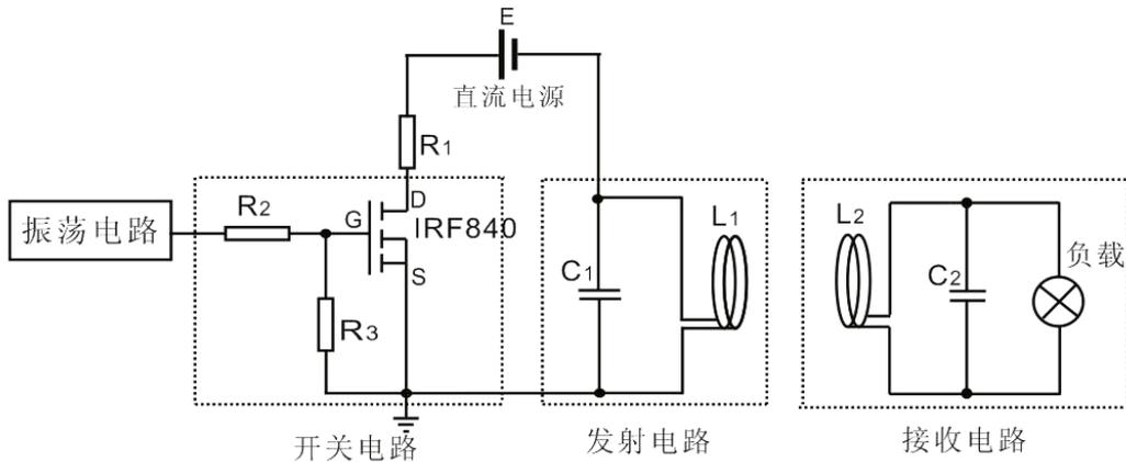
固定接收线圈与发射线圈的距离，如 20 厘米。将增强线圈放置在发射线圈和接收线圈之间，移动增强线圈的位置使小灯泡亮度最大，然后改变信号源的输出频率，利用示波器测量负载灯泡上的电压峰值，完成如下表格并绘制幅度-频率曲线。
