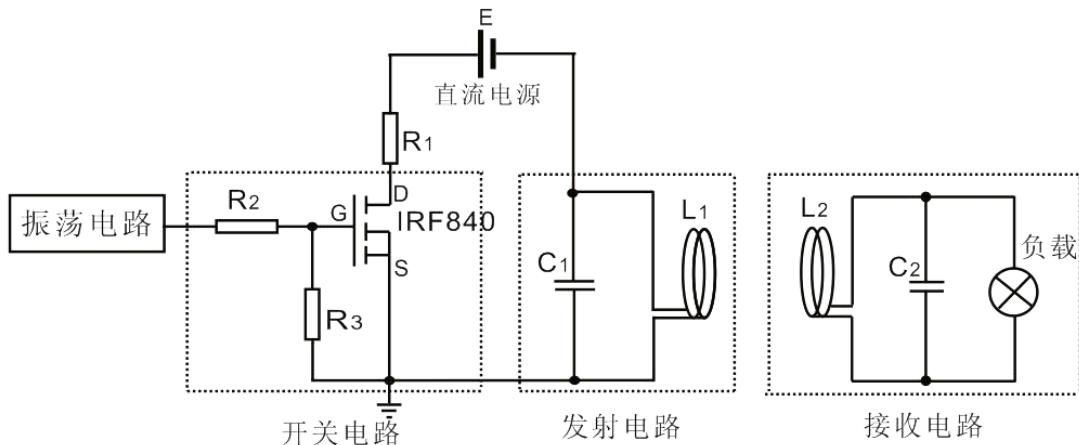
固定接收线圈与发射线圈的距离，如 20 厘米。将增强线圈放置在发射线圈和接收线圈之间，移动增强线圈的位置使小灯泡亮度最大，然后在系统固有谐振频率（约 2.2 MHz）附近改变信号源的输出频率，利用示波器测量负载灯泡上的电压峰值，完成如下表格并绘制幅度-频率曲线。
